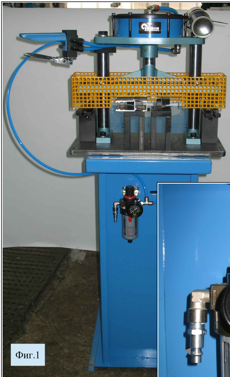
Входной штуцер для подсоединения к воздушной магистрали
