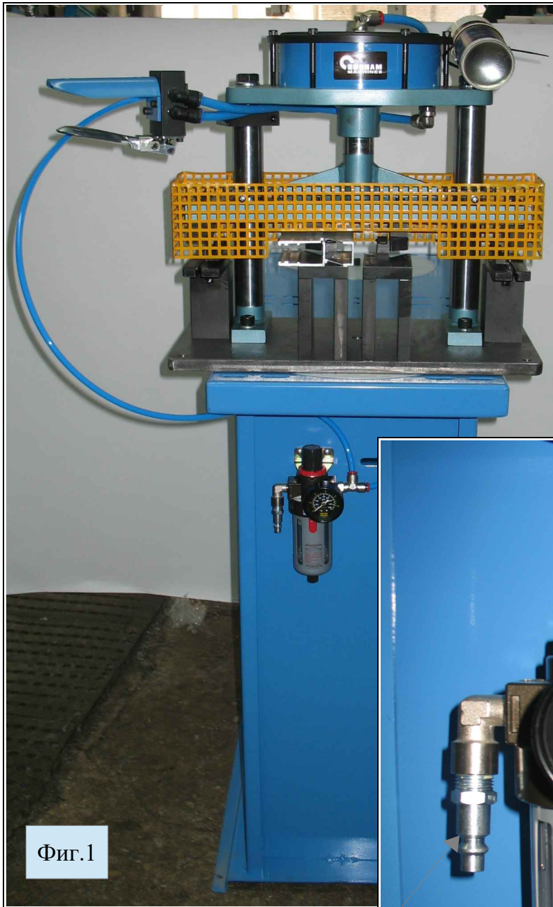
Входной штуцер для подсоединения к воздушной магистрали
