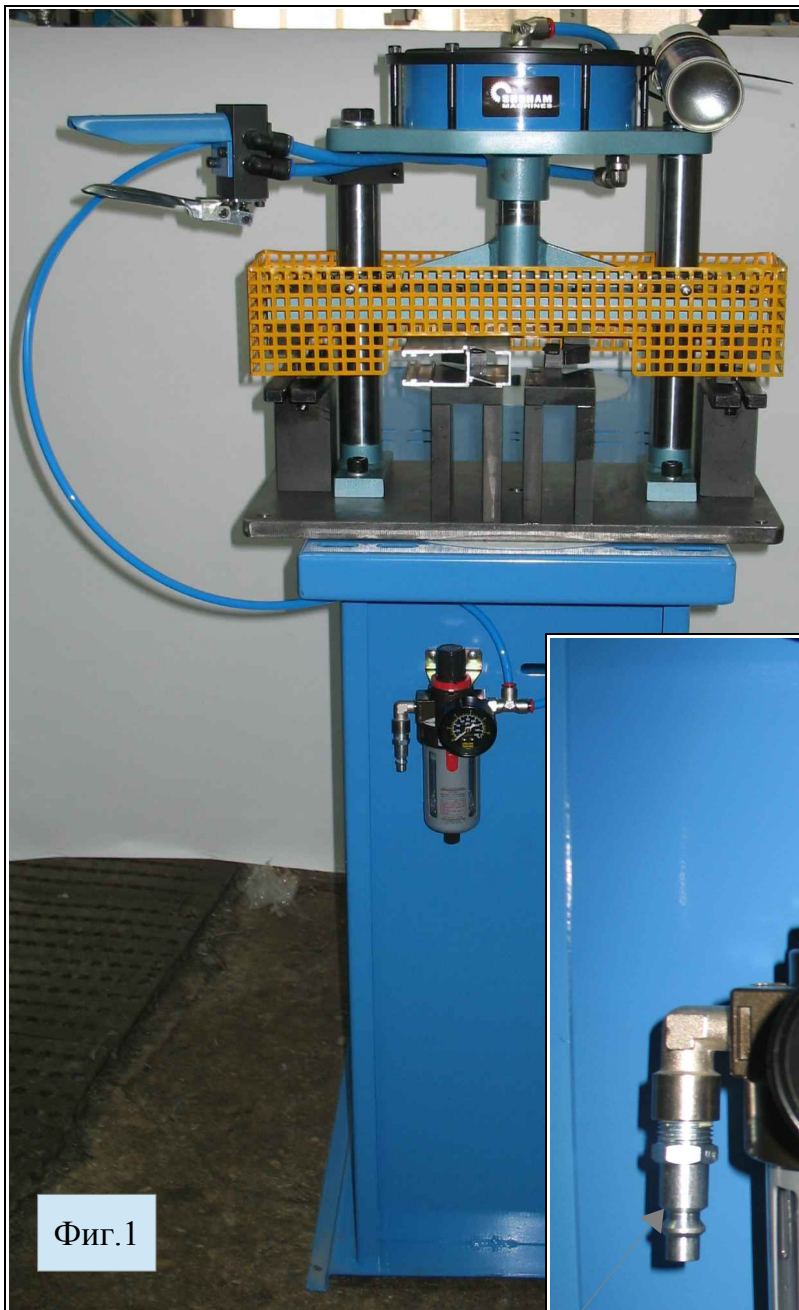
Входной штуцер для подсоединения к воздушной магистрали
