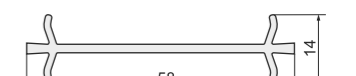
Арт. B16 (арт. VEKA - 116.010) Соединительный профиль: VEKA 58 мм, PLAFEN 58 мм Classic-line, RIGAP, OPAC
